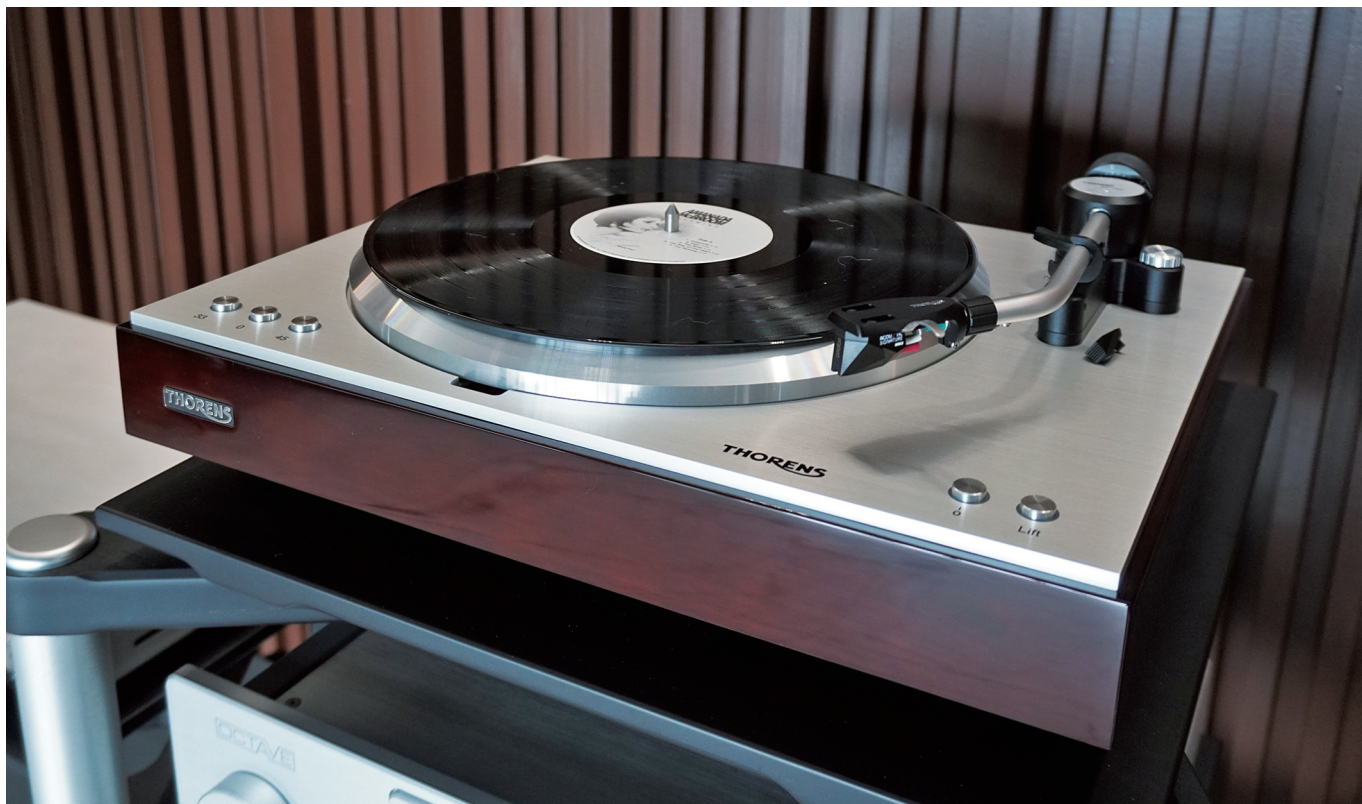
技术参数 ■ 驱动方式：马达驱动 ■ 转速：33 1/3 转，45转，78 转 ■ 唱臂：Thorens TD160 J 型臂（可更换唱头盖） ■ 转盘重量：3.2kg（铝合金材质） ■ 有效臂距：232.8mm ■ 超距：17.8mm ■ 抗侧滑：有，弹簧式 ■ 尺寸：450 x 160 x 370 mm ■ 重量：12.3 kg
